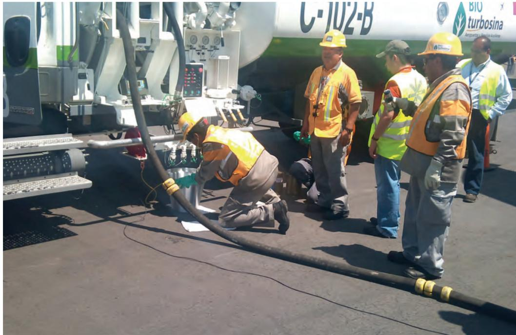
Realizando pruebas de calidad previas a un vuelo con biocombustible. Foto: Archivo ASA.
